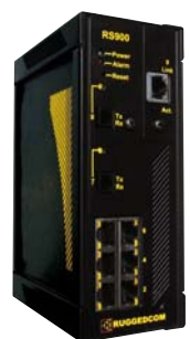
9-portový dálkově řízený ethernetový přepínač s optickými uplinky.
